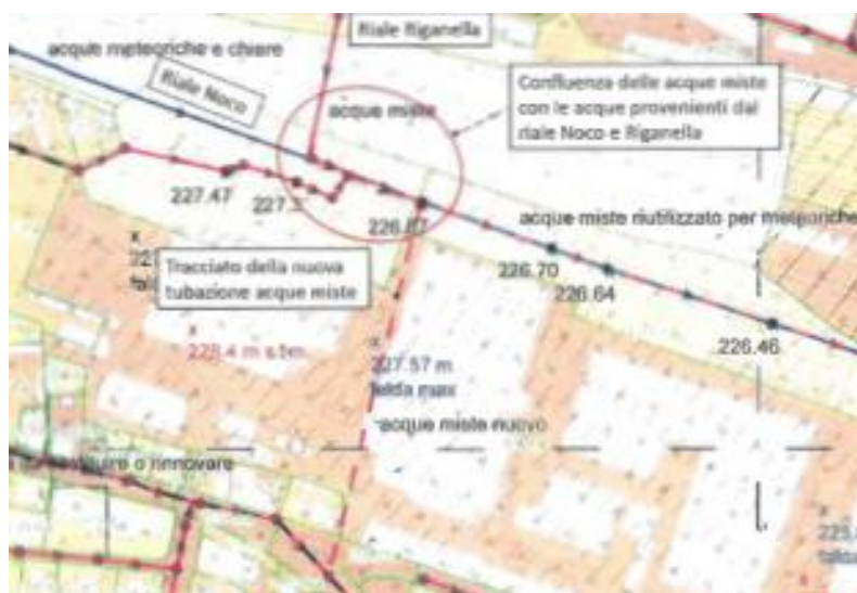
Figura 9: estratto del PGS. In blu i corsi d'acqua, in rosso le canalizzazioni delle acque luride, in tratteggio blu e rosso le canalizzazioni acque miste.
